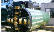
②導水路（巨礫対応推進工法）
