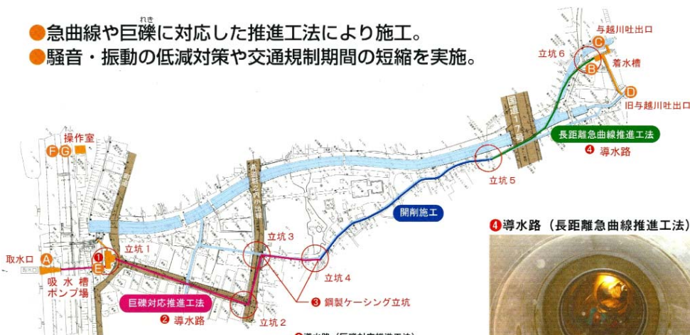
②導水路（巨礫対応推進工法）
